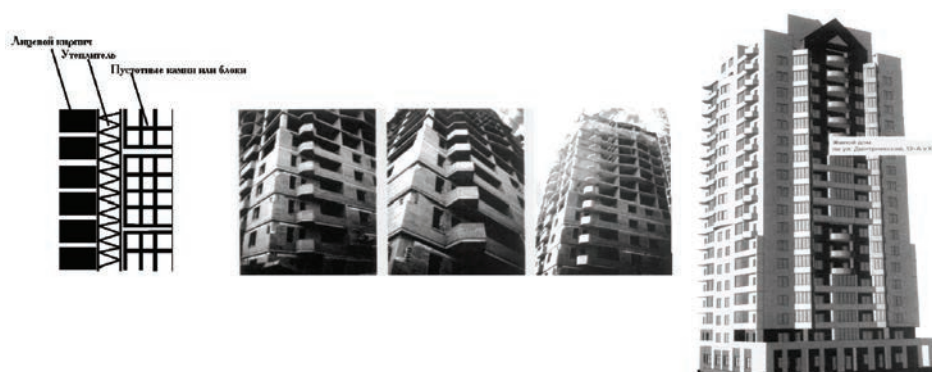
Рис. 4. Схема многослойной конструкции „теплых“ стен и пример строительства здания, в котором они использованы фирмой "Познякижилстрой"
